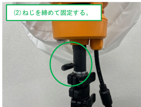
照明本体接続治具とスタンションの上端部
